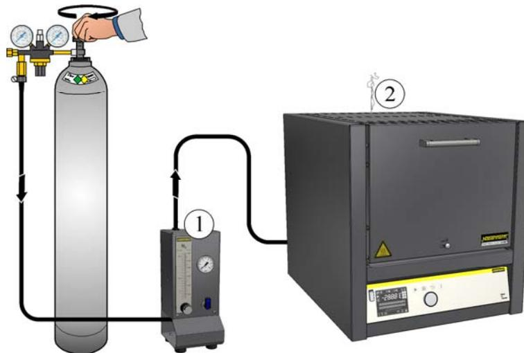
Fig. 44: Collegamento al sistema di gasaggio (illustrazione simile)
