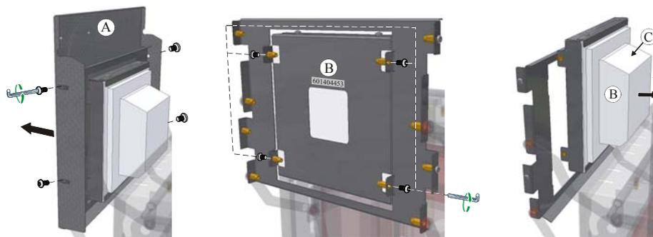
Fig. 42: Smontaggio del rivestimento/della struttura isolante della porta (illustrazione simile)
